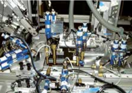
Esempio di batteria di micro-dosatori MVP, su linea automatica di assemblaggio.
