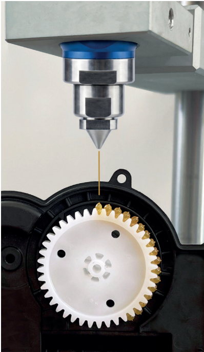
Dosaggio a impulsi senza contatto su ruote dentate.
